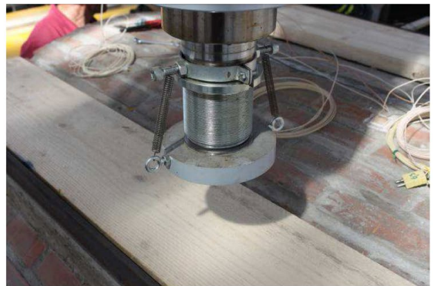
26/5/2015 – figura 45 Particolare della testa semisferica di applicazione del carico
