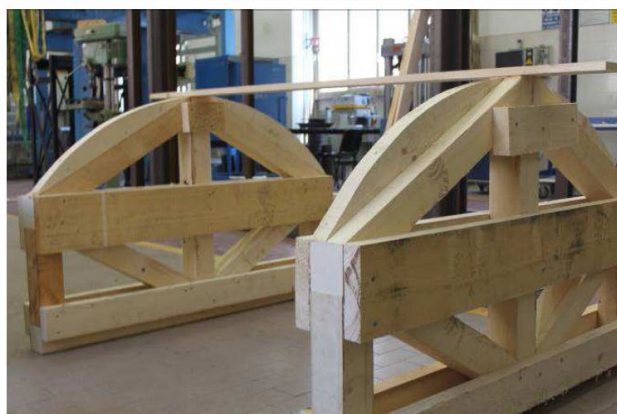
4/5/2015 – figura 14 Prova di accoppiamento di due centine
