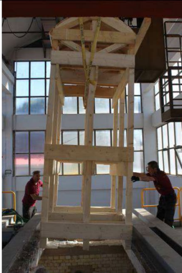
12/5/2015 – figura 24 Posizionamento della centina nel forno orizzontale
