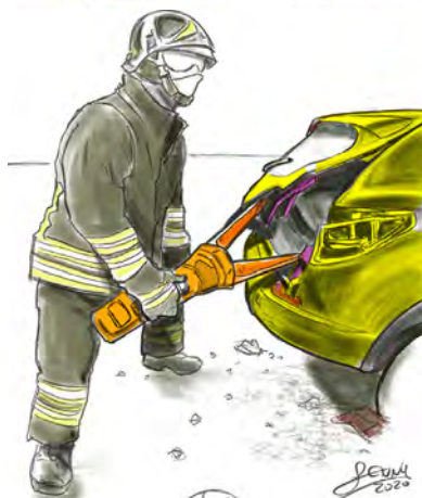
Uso del divaricatore tra il portellone posteriore (un elemento mobile / elastico) e il telaio (elemento fisso/ plastico)
