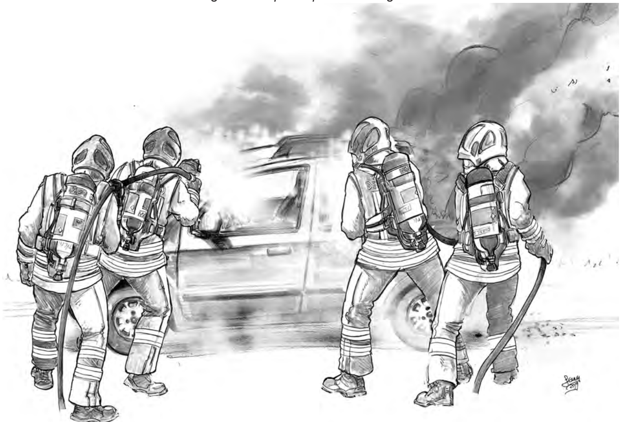
Un binomio indirizza il getto dell'acqua sulla parte anteriore dell'abitacolo per estinguere le fiamme e ridurre l'irraggiamento del serbatoio, il secondo binomio si occupa del raffreddamento del serbatoio per evitare l'eventuale apertura delle valvole di sicurezza
