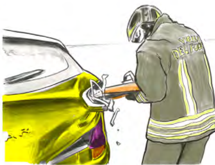
Rimozione del fanale posteriore
