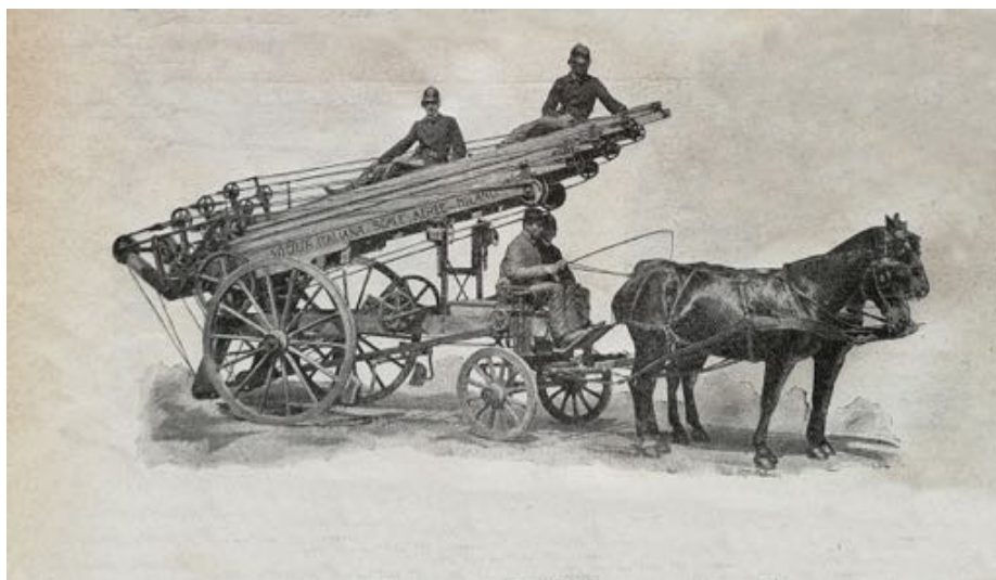
Fig. 8 -Immagine della Scala tipo Canciano prodotta dalla società milanese L'Italiana, pubblicata nel 1906 sulle pagine della rivista "Federazione Tecnica Italiana dei Corpi di Pompieri".
