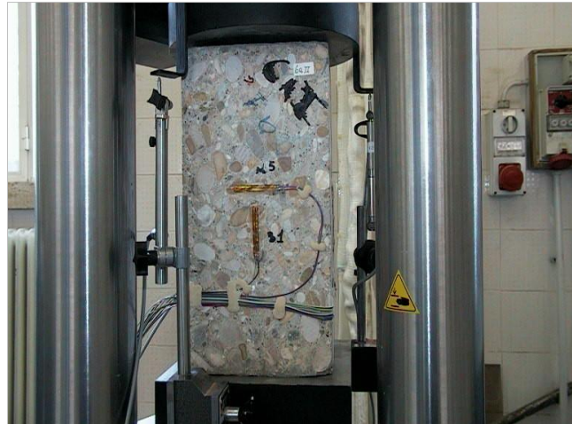
Figura 2.19 Campione di prova sottoposto a compressione
