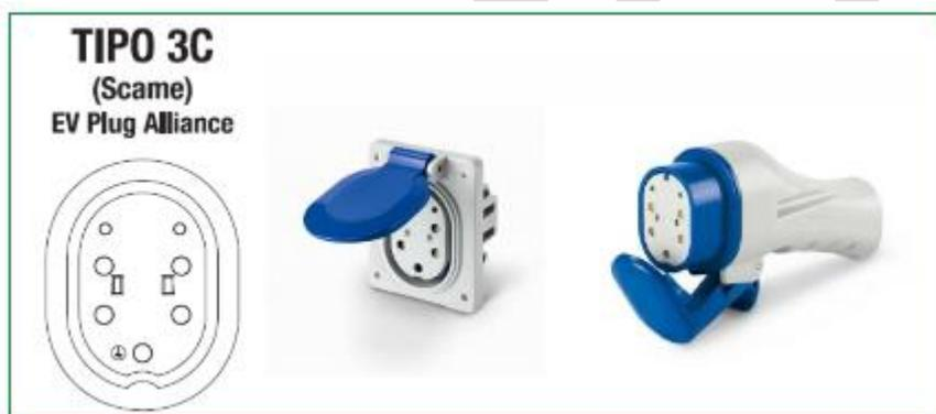
Mono/trifase, 2 contatti pilota, max 32A (63A), 230/400V, si trova solo sulle colonnine, è ormai in disuso.
