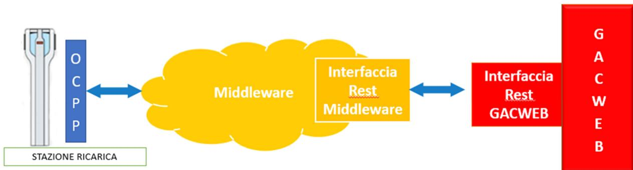
*Figura 8 – Schema di interfacciamento middleware tra colonnine e GACWEB*
