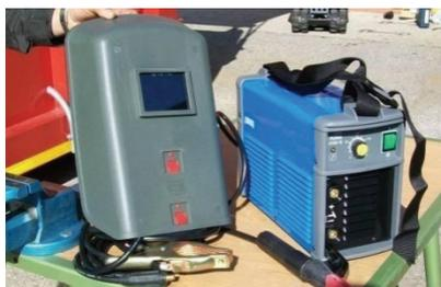
Figura 5.16 Saldatrice ad inverter.
