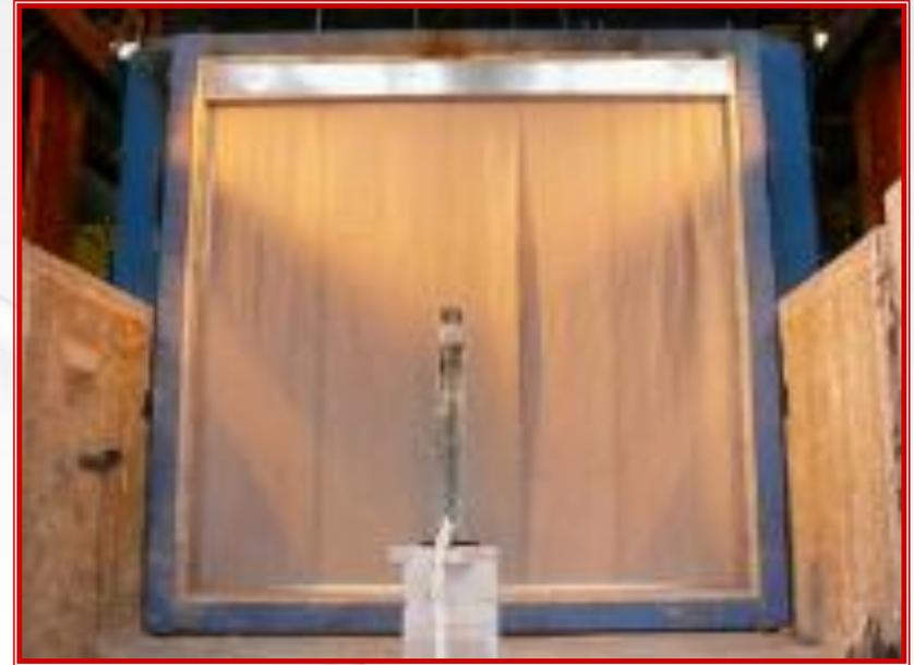
*Il requisito radiazione  $W$  è la capacità dell'elemento resistente al fuoco di ridurre la probabilità di trasmissione dell'incendio come risultato del passaggio di un notevole calore radiante sia attraverso l'elemento che dalla sua superficie non esposta ai materiali adiacenti. Il requisito  $W$  può anche essere inteso per proteggere le persone nelle vicinanze (non a contatto) dell'elemento di separazione.*
