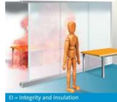
La tecnologia che permette la realizzazione dei vetri in classe “EI” prevede obbligatoriamente l’utilizzo di uno speciale gel intumescente che gonfia ed opacizza con il calore mantenendo “fredda” la superficie esterna.
