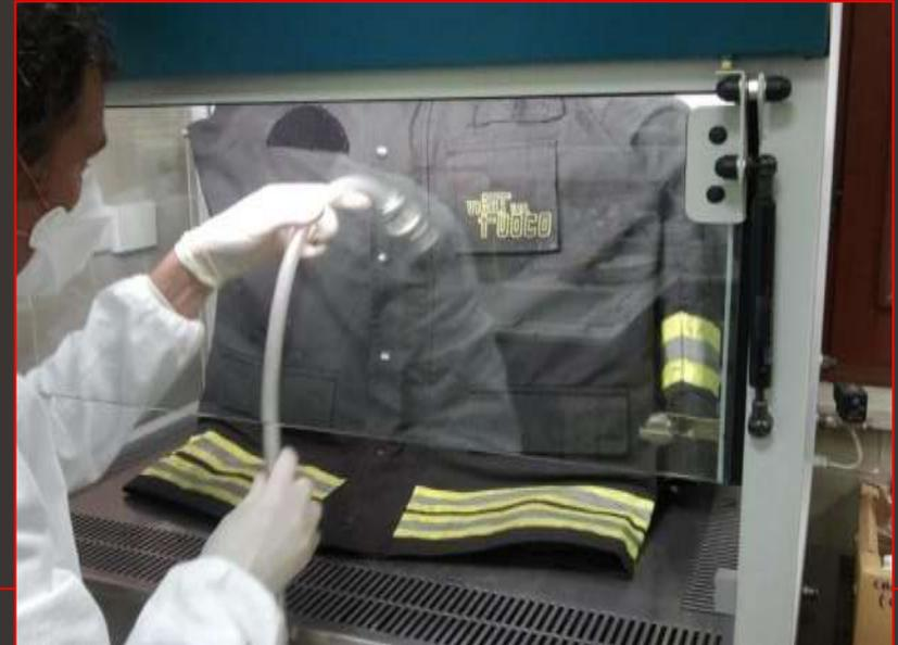
**Campionamenti per aspirazione in diversi punti della tuta per valutare la presenza di eventuali fibre (per i giacconi, una superficie di circa 800 cmq, inferiore per gli spallacci), ad un flusso pari a 10 l/min., su membrana con successiva analisi in SEM**
