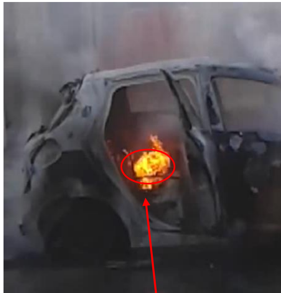
Pacco batterie con coperchio termofusibile (Fire-access),
