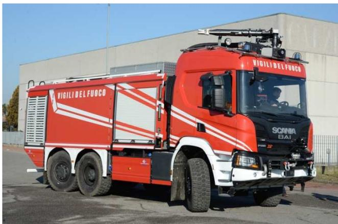
**Serbatoio acqua:** capacità totale da 8100 l in polipropilene.
