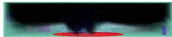
VISTA IN SEZIONE DEL FUMO AL TEMPO t = 395.5 s - SCENARIO STANDARD CON FINESTRE CHIUSE
