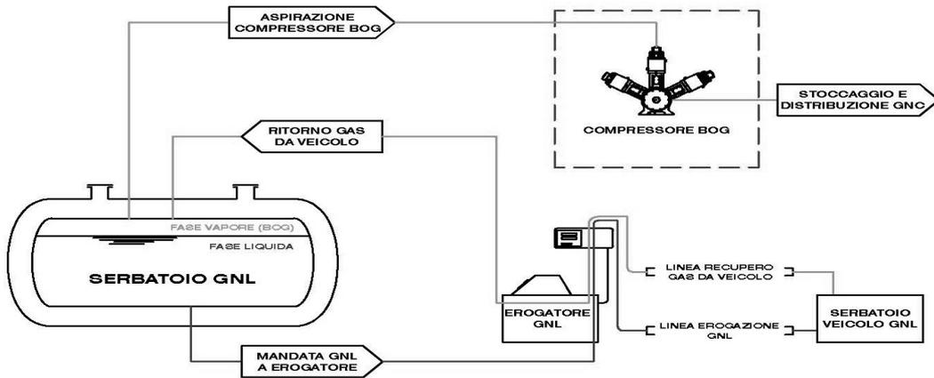
**A2 - SISTEMA CON SERBATOIO DI SMORZAMENTO**
