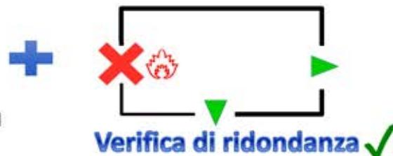
**SOLUZIONE CONFORME: 3 VIE DI ESODO ORIZZONTALI DI LARGHEZZA ≥ 900 mm**
