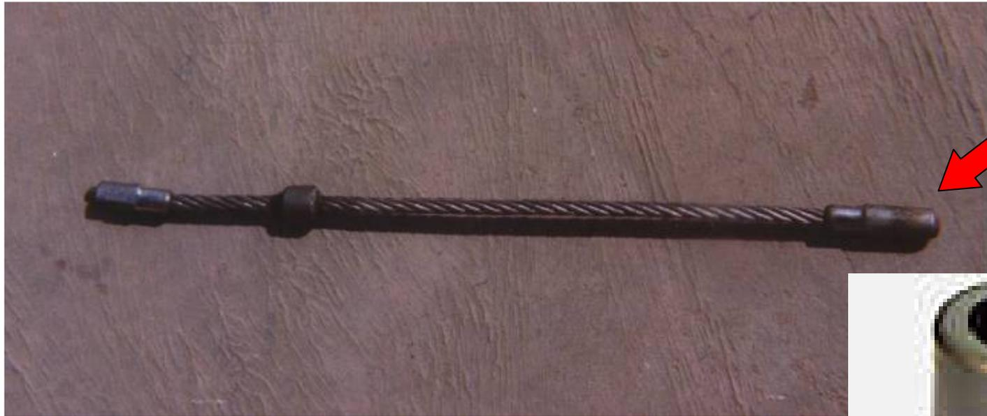
*Alloggiamento sorgente di Ir 192 o Co 60 per controlli non distruttivi*
