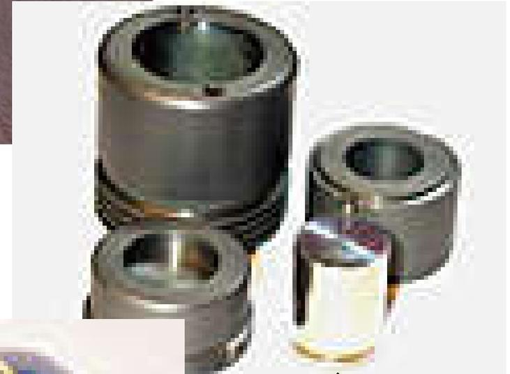
*Alloggiamento di sorgente di Ra 226 per controlli non distruttivi*
