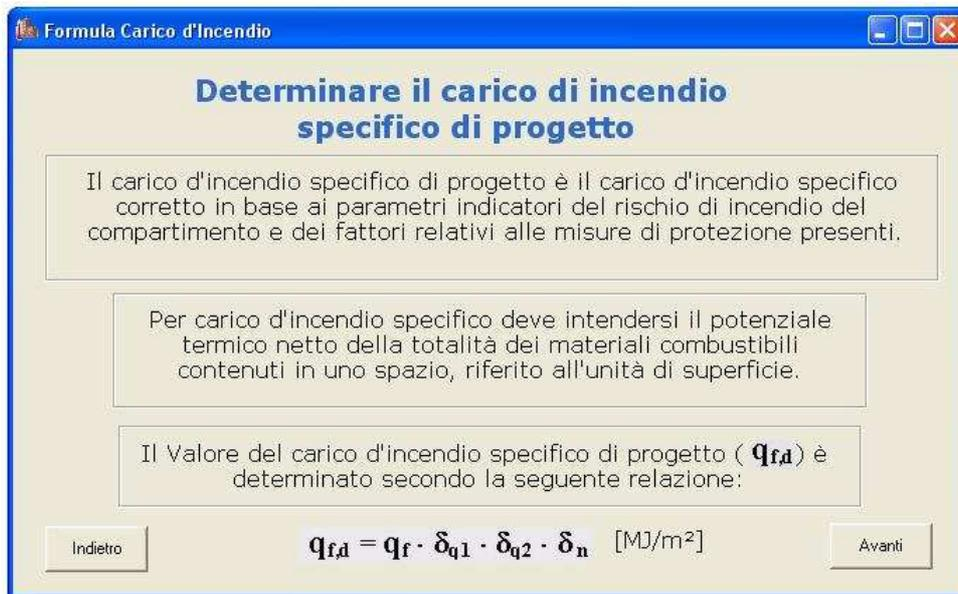
In questa maschera, vengono richiamate la definizione di **carico di incendio specifico** ( $q_f$ ), citata all'Allegato 1, del [D.R.1], e la relazione attraverso la quale deve essere determinato il **carico di incendio specifico di progetto** ( $q_{f,d}$ ), così come definito in [D.R.1], Art. 2, comma 1.
