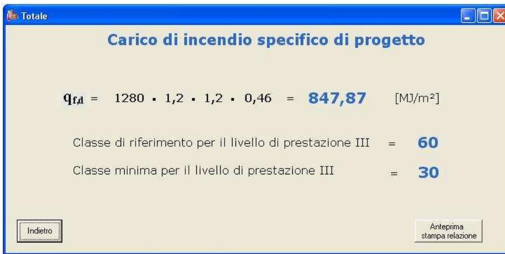
In questa maschera viene fornito il valore del carico d'incendio specifico di progetto relativo al compartimento analizzato, insieme al valore di ciascun coefficiente necessario per calcolarlo.
