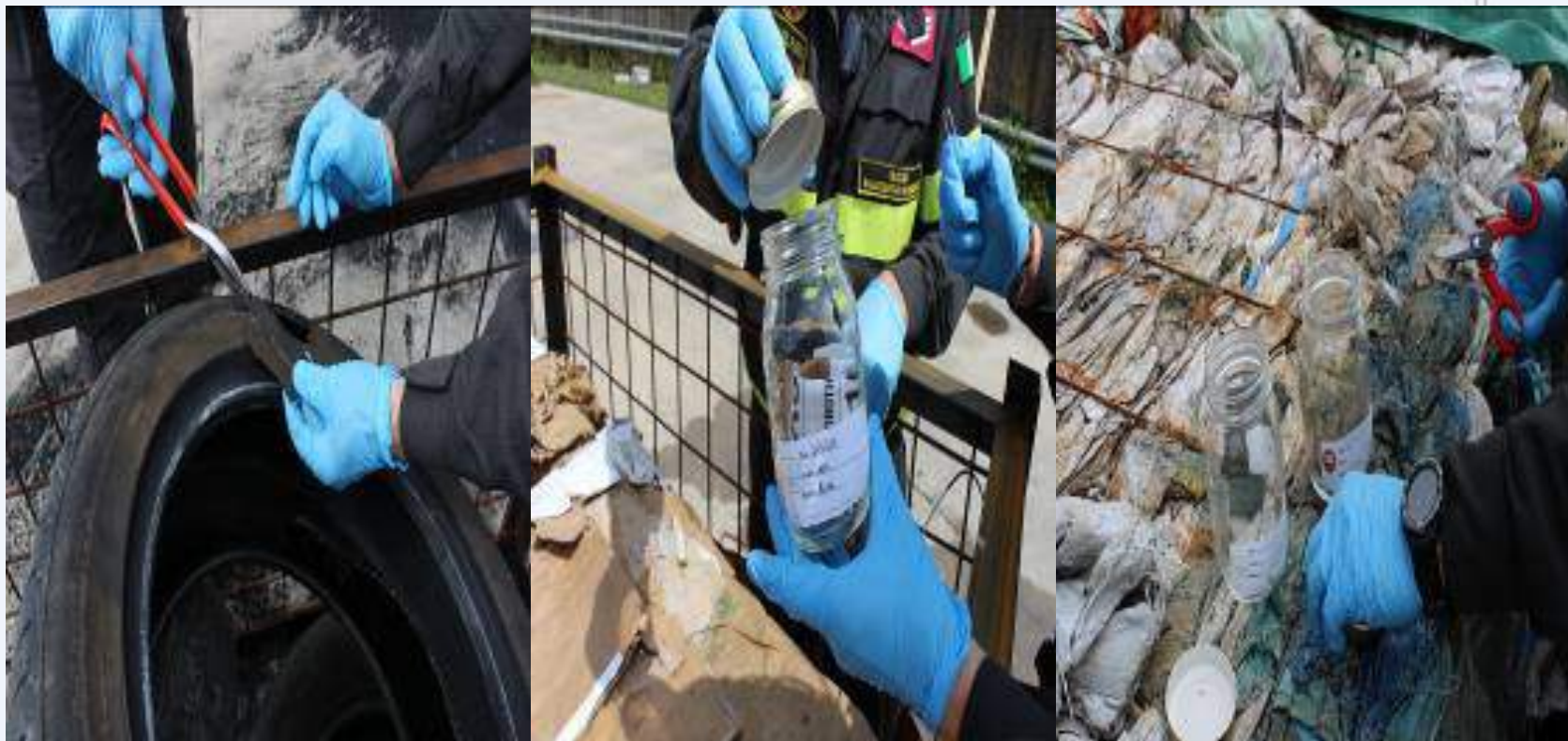
Figura 10 a,b,c : Campionamento Bianco dei Materiali pre-combustione
