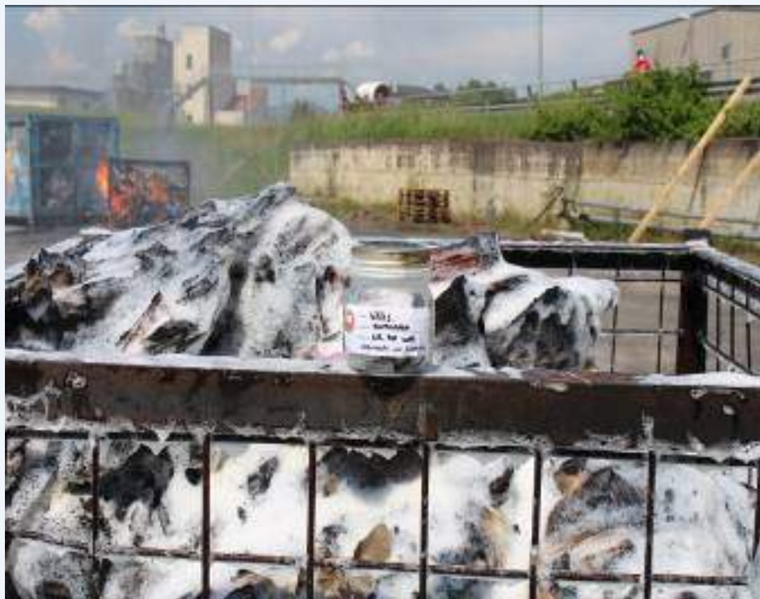
Figura 11 : Campione post combustione e spegnimento
