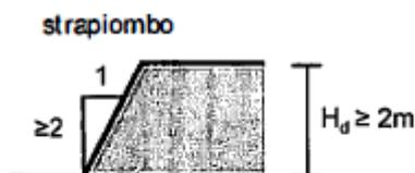
**Figura 1 - Caratteristiche geometriche di un dislivello a strapiombo**
