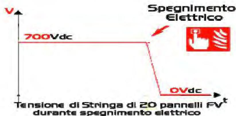
Terminata la necessità di messa in sicurezza, sarà possibile riavviare la produzione di energia, interagendo semplicemente con l'elettronica master ES (la centralina) del sistema SCS.
