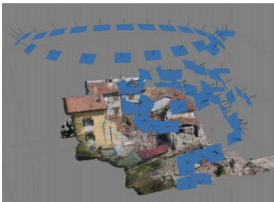
Figura 5 - volo in modalità mista semi automatica e manuale
