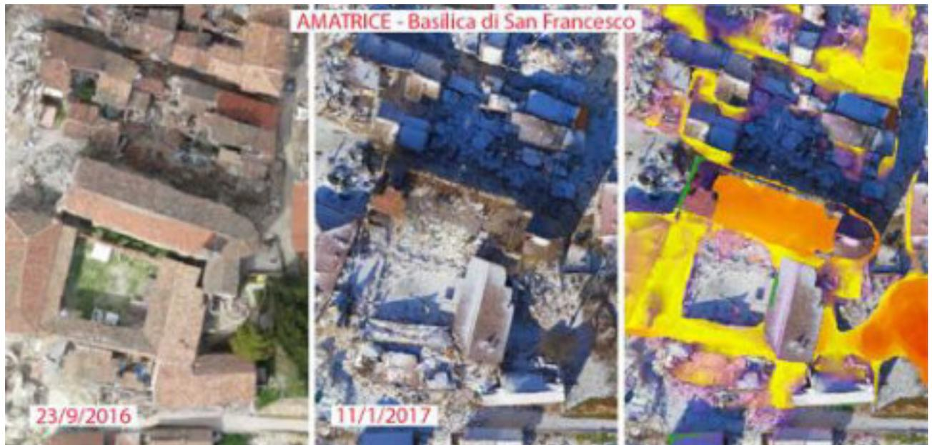
Figura 11 - Esempio di analisi dei cambiamenti su Amatrice tra due scosse (Analisi fatta su DSM)
