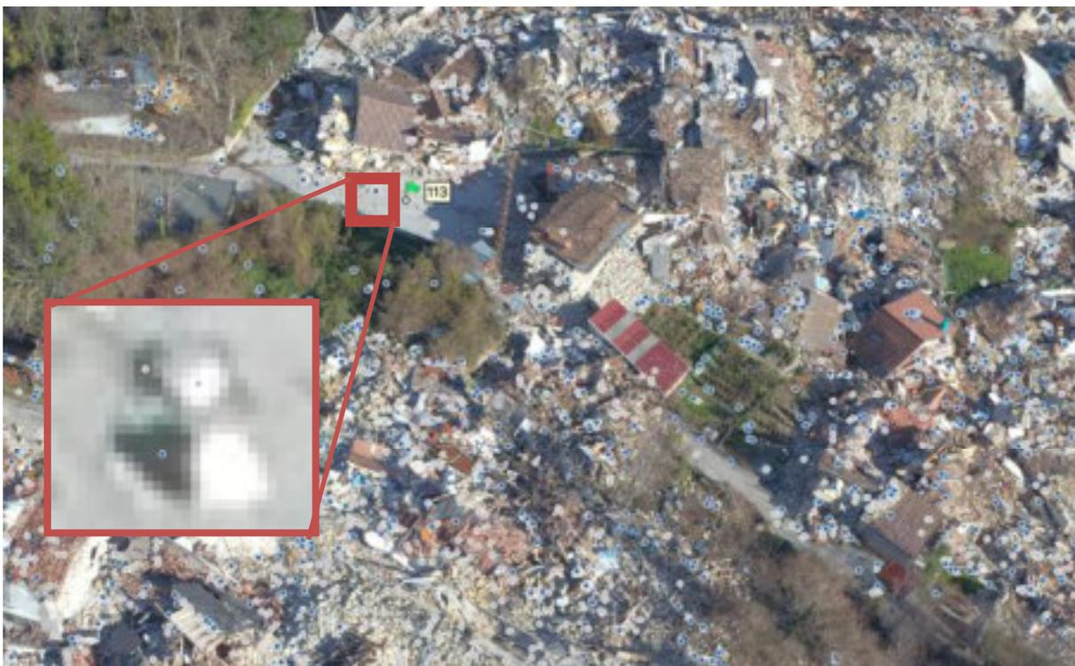
**Figura 1 - Esempio di punti utilizzati per l'unione di fotogrammi adiacenti**
