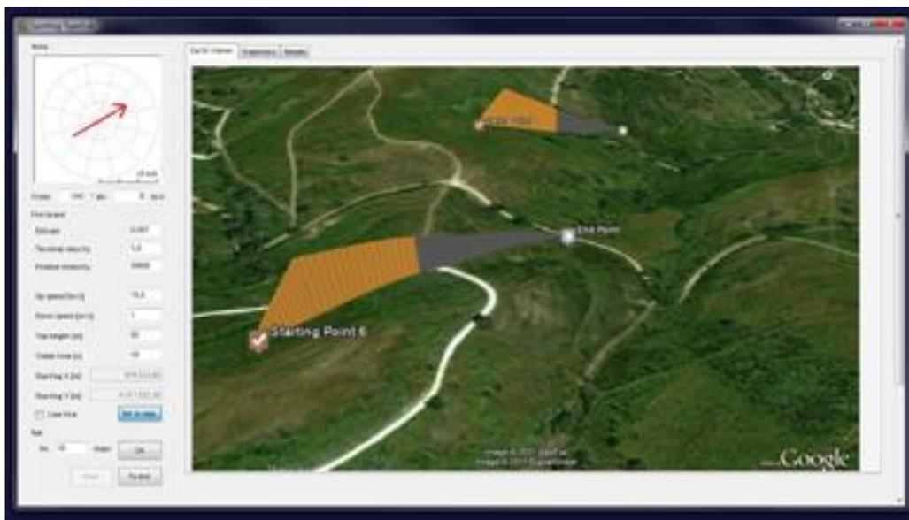
Figura 6: Simulazione di due eventi di “fire spotting” nel software Tiger Lab.
