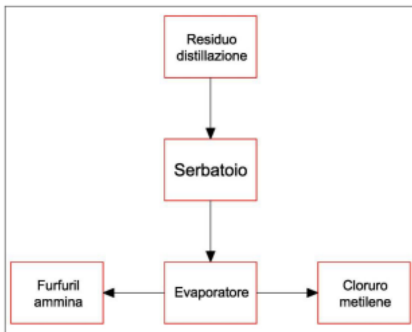
Figura 1. Schema a blocchi – recupero furfurilammina
