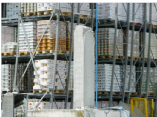
Figure 11, 12. Instabilità delle scaffalature in magazzini intensivi
