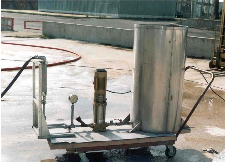
Fig.1: apparecchiatura per la erogazione della soluzione schiumogena
