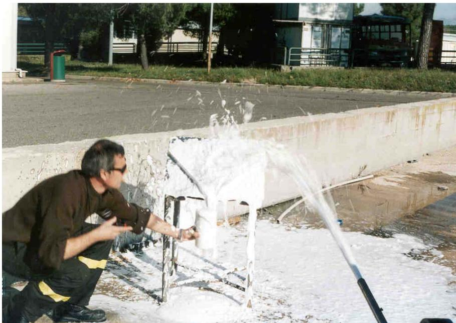
Fig.2: raccolta della schiuma erogata nel recipiente cilindrico
