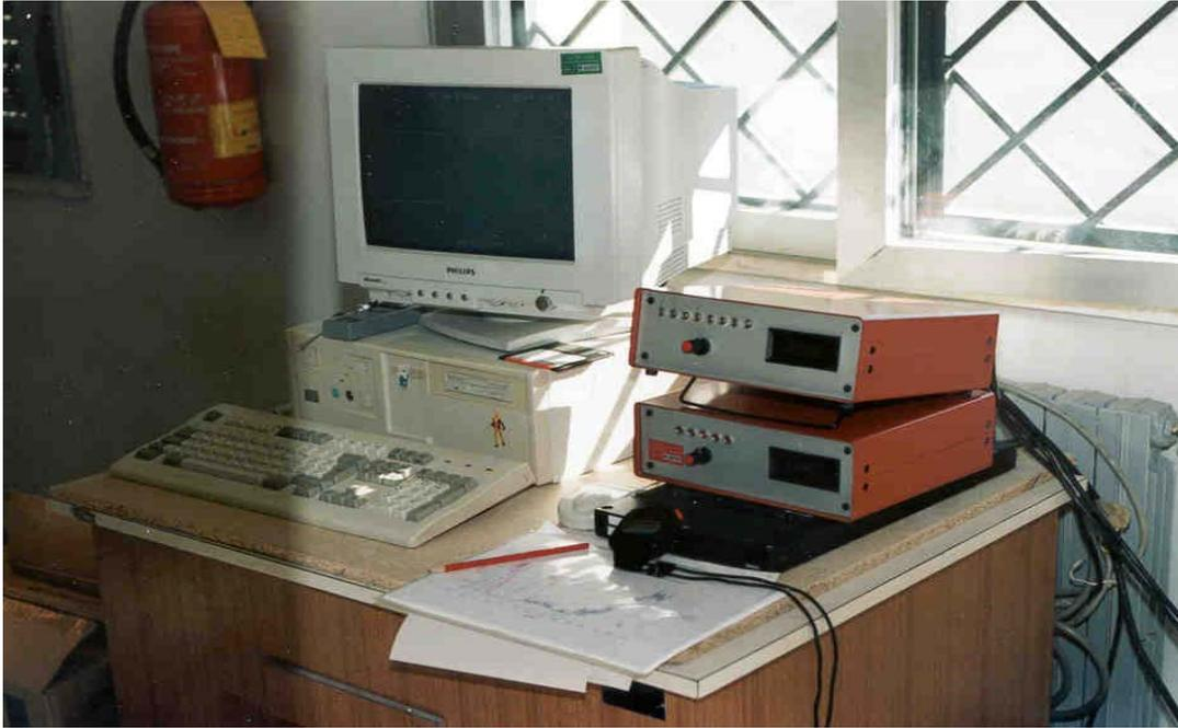
Fig. 5: apparecchiatura per la misura del potere emissivo
