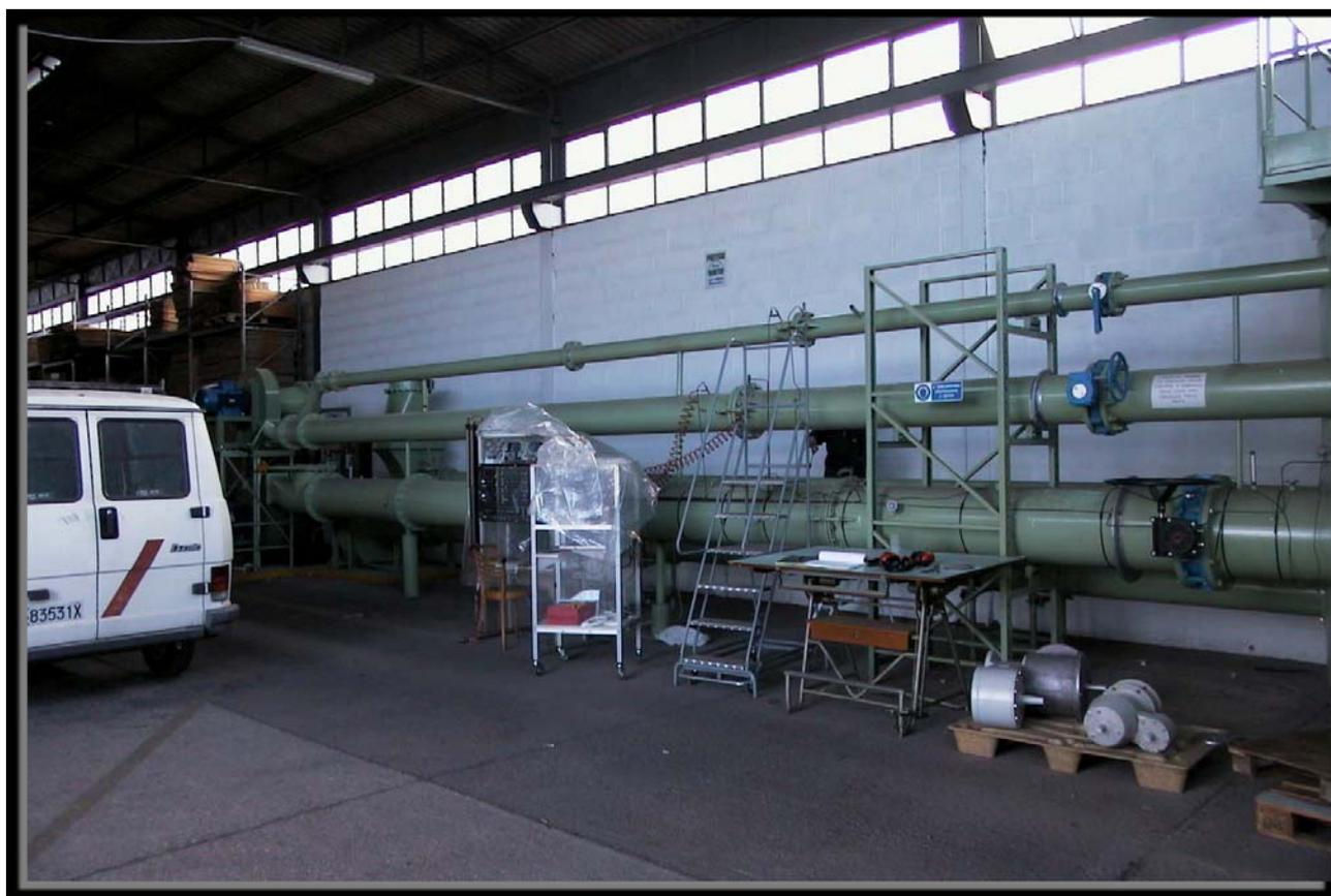
Foto 5 – Prova su valvola d'intercettazione ciclo chiuso
