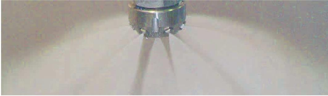
L'impianto antincendio Water Mist è un sistema ad acqua ad alto potere di spegnimento, operante a pressioni comprese tra gli 80 e 140 bar, in grado di produrre una nebbia composta da particelle di dimensioni pari a 50-120  $\mu\text{m}$  ( $1 \mu = 1$  milionesimo di metro) in grado di controllare l'incendio attraverso i seguenti meccanismi:
