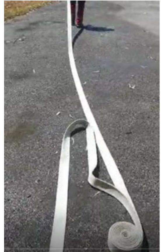
c) Ad avvenuta completa estensione della tubazione, girandosi indietro, si accerta che la condotta non abbia spire tali da determinarne delle strozzature (se del caso ruota la tubazione) e tornando verso la cassetta idranti, aziona la valvola per mettere in pressione la tubazione.
