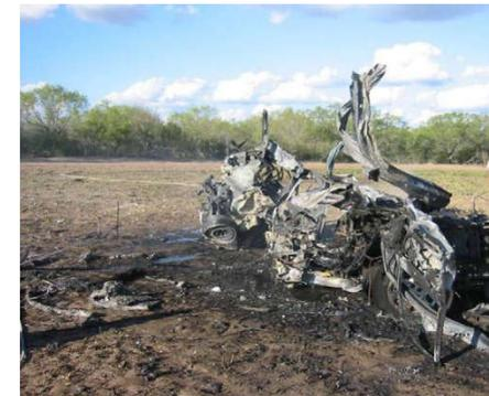
Danno all'uomo da rottura di un serbatoio stand-alone in un incendio
