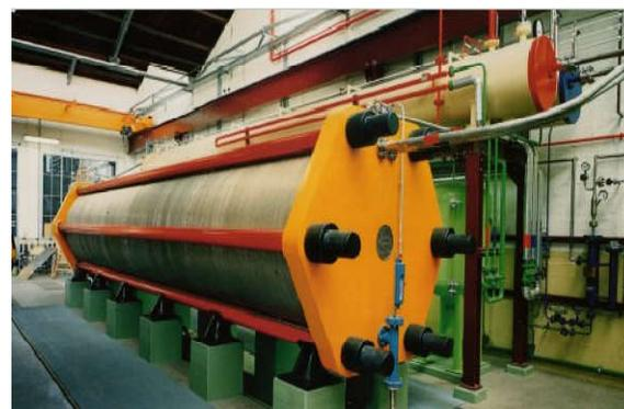
Elettrolizzatore alcalino IHT tipo S-556, 760 Nm<sup>3</sup>/h e 3 bar
