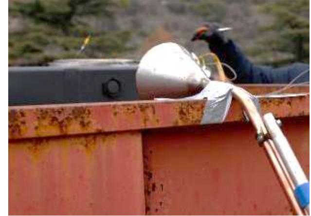
Collettore raccolta fumi/gas in uscita dalla valvola di VENT
