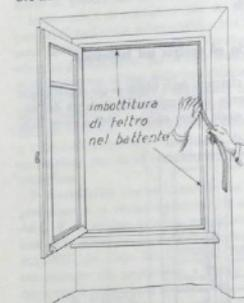
Fig. 3. - Chiusura delle fessure.
