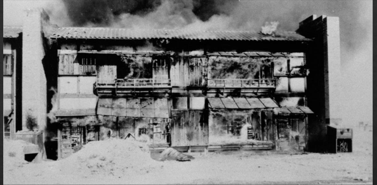
Test incendiari dell'M-69 sulle strutture in stile giapponese al Dugway Proving Ground.
