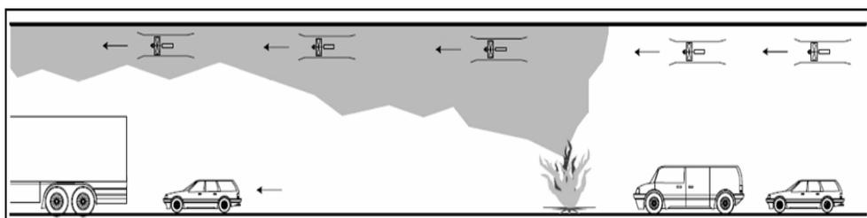
Ventilazione naturale: flusso di aria che si instaura all'interno della galleria dovuto alla differenza di pressione tra i portali, alla pendenza del tunnel e alla differenza di temperatura tra la superficie delle strutture della galleria e l'aria ambiente.
