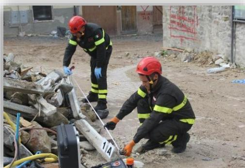
Uno degli aspetti cruciali del rilievo geometrico-dimensionale è la misurazione delle distanze relative tra i punti di riferimento e i materiali ritenuti utili ai fini delle indagini.
