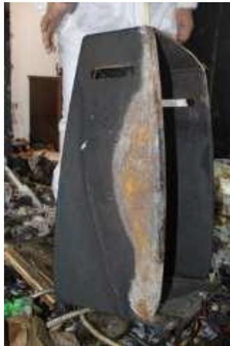
La foto in alto mostra un'evidente "linea di demarcazione", lasciata impressa sul muro per effetto del fumo e del calore che si sono sprigionati durante l'incendio. La foto sopra mostra sempre una linea di demarcazione, lasciata dal calore sulla superficie metallica di una stufetta.
