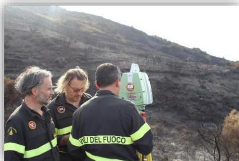
Oltre agli aspetti strettamente geometrici, il laser scanner consente anche di acquisire informazioni di tipo visivo sulla scena dell'incendio. Infatti, attraverso l'integrazione di una fotocamera digitale ad alta risoluzione, lo strumento è in grado di catturare immagini sferiche panoramiche che documentano in maniera dettagliata l'aspetto
