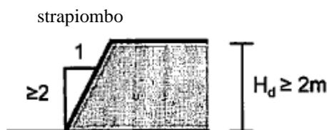
Figura 1 - Caratteristiche geometriche di un dislivello a strapiombo
