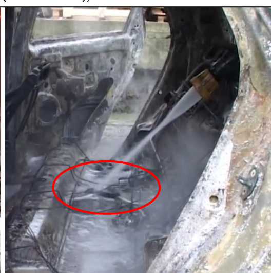
Pacco batterie con coperchio termofusibile (Fire-access),
