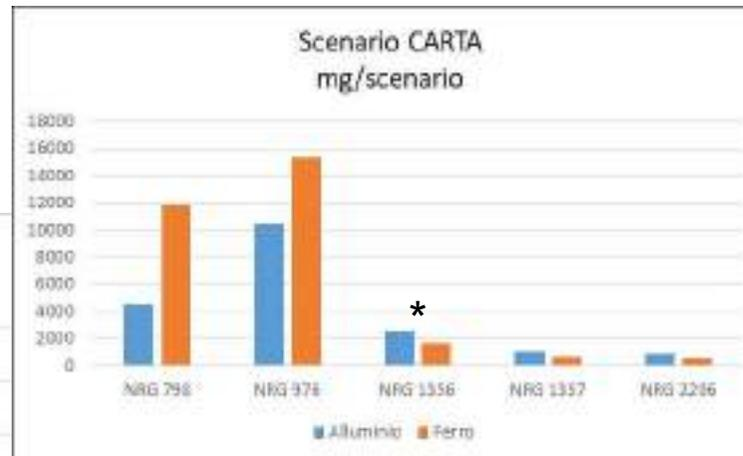
Rispetto ai risultati ottenuti sugli altri scenari, con la carta si sono rilevati maggiori contenuti di **Boro** probabilmente dovuto alla sua normale presenza nel materiale testato visto che l'acido borico  $H_3BO_3$  viene utilizzato nei processi di produzione industriali della carta. Sali di boro sono inoltre comunemente utilizzati come ritardanti di fiamma negli schiumogeni. Il boro riscontrato (in media intorno ai 300 mg/prova) è dovuto quindi alla somma di entrambi i contributi.
