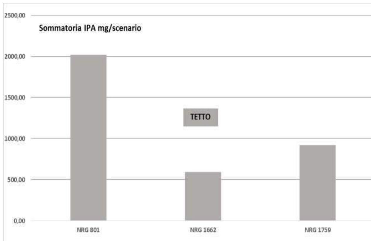
Quantità molto più significative di IPA si sono riscontrate nel caso dello scenario **tetto ventilato** con un valore di picco intorno ai 2000 mg/scenario e un valore medio calcolato sulle relative prove di circa **1000 mg/scenario**.
